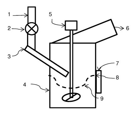
Bio massa matas in vid (1) via sluss (2) för att utestänga luft samt vidare genom skruv (3) till pyrolys reaktor (4).
